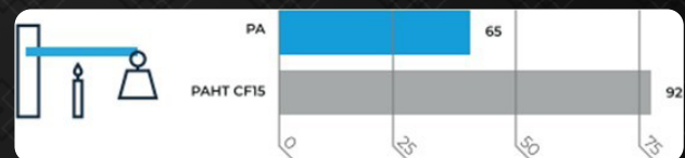
Figura 5: Temperatura de deflexão térmica (1,82 MPa), em °C, do Ultrafuse® PA e Ultrafuse® PAHT CF15. Fonte: BCN3D.
